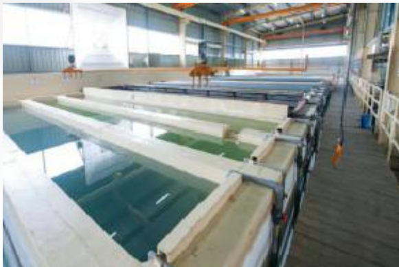
Hệ thống Xi mạ (Anodized) (Giai đoạn 2025)
